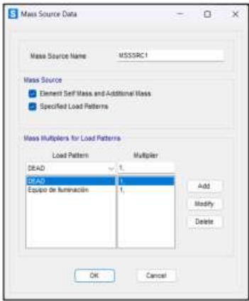
Ilustración 4: Definición de fuente de masa sísmica en SAP2000.
